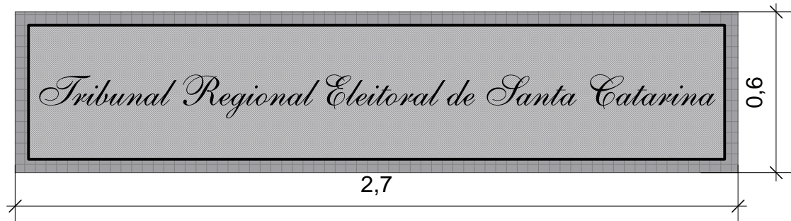
ITEM 3: 02 (dois) capachos em frente às portas frontais (externo) - térreo 02 (dois) capachos para as portas do salão (externo) - ático
