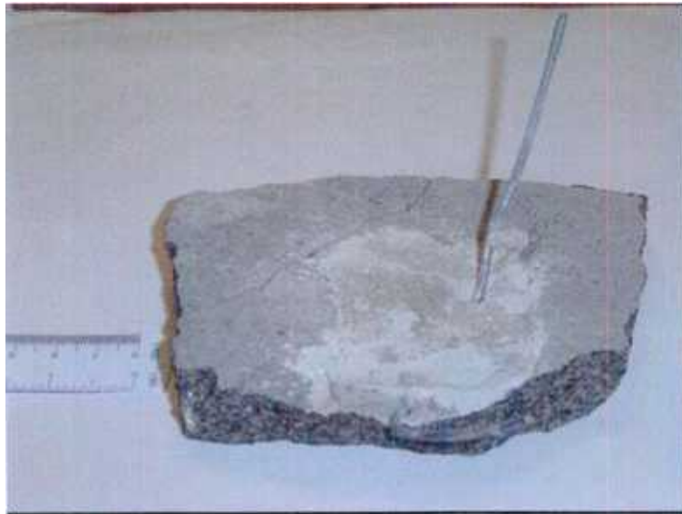
Fotografia 1 – Fragmento da placa descolada com gancho aplicado em seu tardo.
