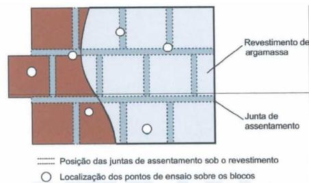
**Figura 2** Posição aleatória dos corpos de prova para a realização dos ensaios
