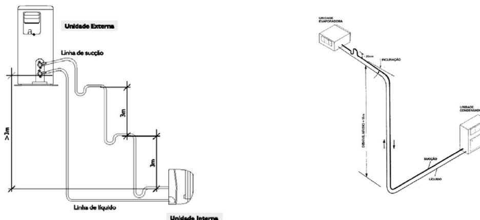
1.3.21. Todas as dobras na tubulação de cobre deverão ser feitas com o auxílio de ferramenta adequada (mola de dobramento), para evitar estrangulamento dos tubos. Em hipótese alguma poderão ser feitas curvas nos tubos com as mãos.
