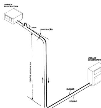
j) Todas as dobras na tubulação de cobre deverão ser feitas com o auxílio de ferramenta adequada (mola de dobramento), para evitar estrangulamento dos tubos. Em hipótese alguma poderão ser feitas curvas nos tubos com as mãos.
