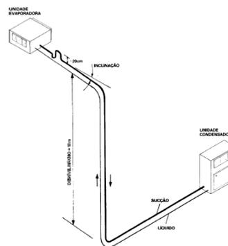
1.2.10. Todas as dobras na tubulação de cobre deverão ser feitas com o auxílio de ferramenta adequada (mola de dobramento), para evitar estrangulamento dos tubos. Em hipótese alguma poderão ser feitas curvas nos tubos com as mãos.
